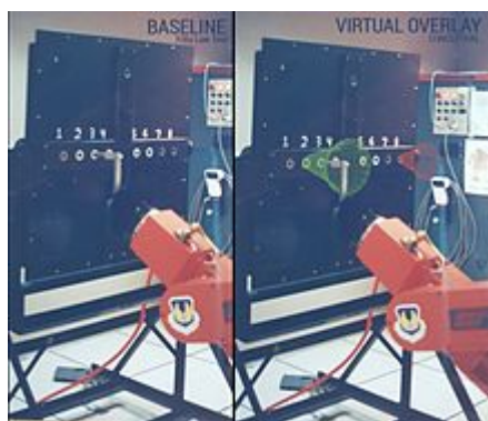
Рисунок 1.1 - Virtual fixtures: Використовується для покращення продуктивності оператора в телероботизованому керуванні завданням на дошці за законом Фітта.
